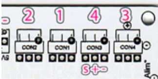
Connecteurs coudés 3 points à détrompeur et verrouillage. Ces connecteurs servent à brancher des rallonges IZ pour capteurs. Ils comportent : masse / 5 Volts / Signal.
